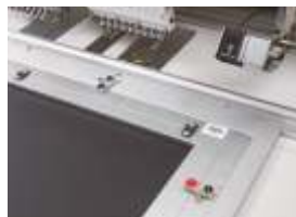
Barcode-Leser Überprüfung der Musterdateien und Materialien, um menschliche Fehler zu vermeiden.
