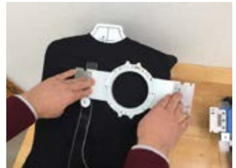
6. Rahmenoberteil wird auf die Halterung gedrückt. Danach lässt sich der Rahmen mit eingespanntem Vlies und Textil einfach abnehmen.
