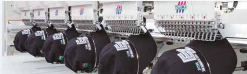
Die Verstärkung des Kappenrahmens hat zur Stabilisierung der Stickoberfläche beigetragen, hierdurch wurde die maximale Stickgeschwindigkeit auf bis zu 1.000 U/min erhöht wurde.
