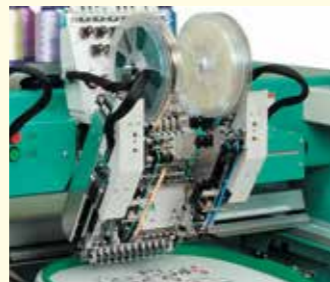
Pailleteneinrichtung Twin Type Verarbeiten von zwei Paillettenarten mit schnellem Wechsel.
