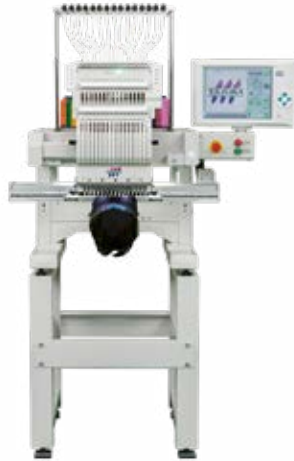
Die automatische Einstellung der Fadenspannung ist das Alleinstellungsmerkmal der Einkopfstickmaschine „TMEZ-SC“.
